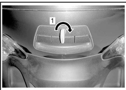
1. Ruotare in senso orario fino al bloccaggio
