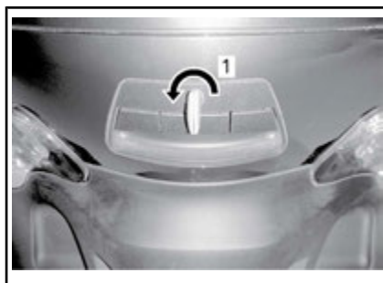
1. Linksom draaien om te ontgrendelen.
