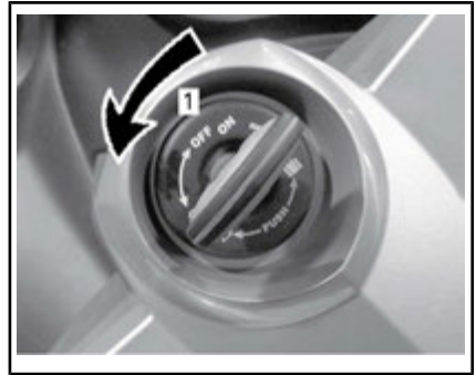
STAND VAN DE SLEUTEL OM HET STUUR TE VERGRENDELEN
