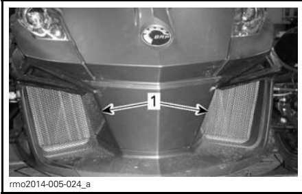
1. Radiator fan grills
