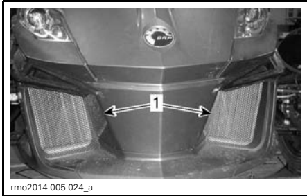
1. Radiator fan grills
