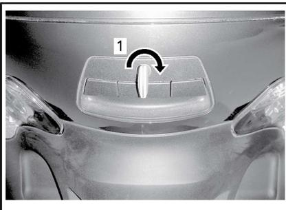
1. Zum Verriegeln im Uhrzeigersinn drehen
