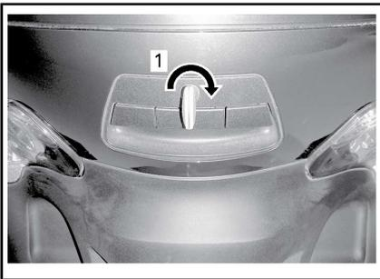
1. Zum Verriegeln im Uhrzeigersinn drehen
