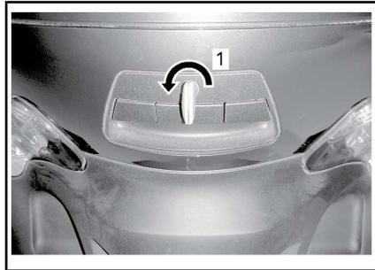
1. Zum Entriegeln gegen den Uhrzeigersinn drehen
