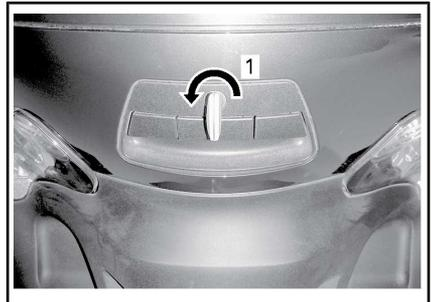
1. Zum Entriegeln gegen den Uhrzeigersinn drehen
