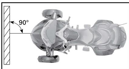
4. Zeichnen Sie wie folgt 4 Linien parallel zum Boden auf die Testfläche:
