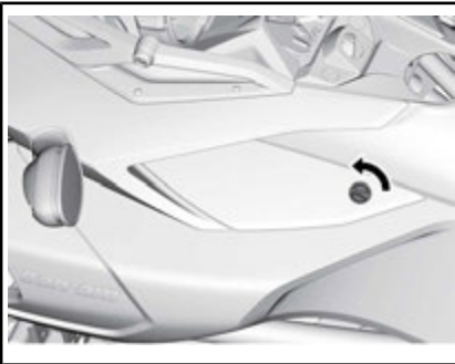
CONFIGURAZIONE TIPICA - COPERCHI DI MANUTENZIONE
