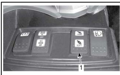
1. Interruptor de ACS
