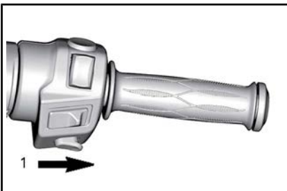
1. Skjut reglaget åt höger
