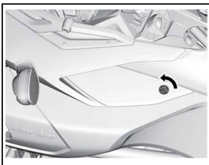
ILLUSTRATO IL COPERCHIO DI MANUTENZIONE SINISTRO
