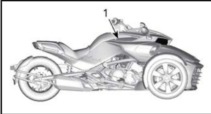
1. Kilpi sijaitsee oikean sivuhuoltokannen alla
