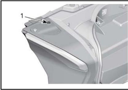
1. Parafuso de retenção superior para remover
