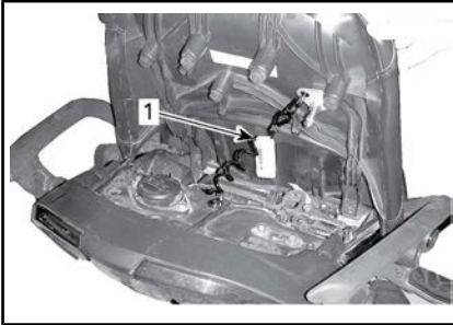
1. Etiket 7 is aan het bindsnoer onder de passagiersstoel aangebracht
