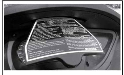
TÍPICO - EXTRACCIÓN DE LA FICHA DE SEGURIDAD
