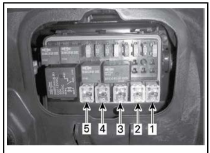
FUSIBLES HEMBRA: CAJA DE FUSIBLES IZQUIERDA
