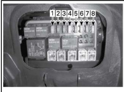
FUSIBLES: CAJA DE FUSIBLES IZQUIERDA
