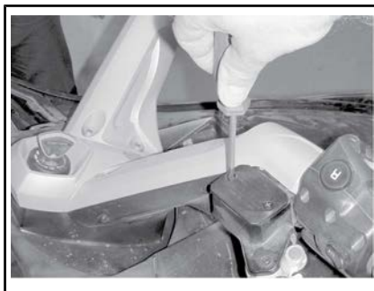
1. Línea de referencia de nivel de refrigerante HOT (caliente)
