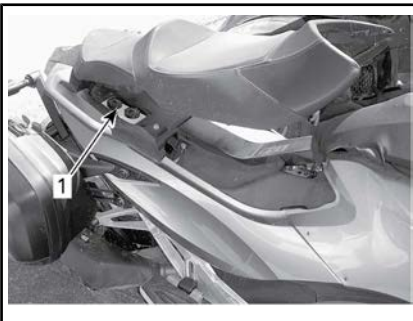
1. Serbatoio del liquido per freni
