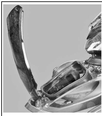
VANO DI CARICO ANTERIORE APERTO
