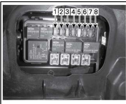
SICHERUNGEN – RECHTER SICHERUNGSKASTEN
