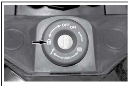
POSIÇÃO DA CHAVE PARA TRAVAR O GUIDÃO
