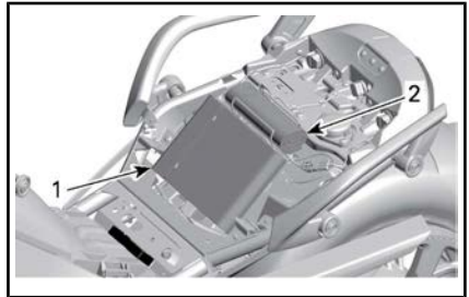
POSIÇÃO DA CHAVE PARA ABRIR O BAGAGEIRO DIANTEIRO
