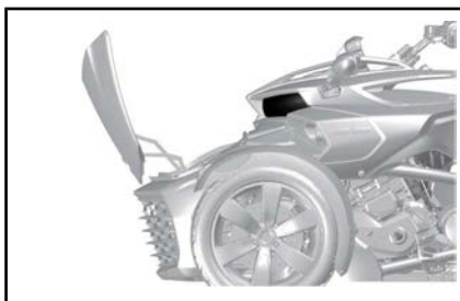
フロントストレージコンパートメントの開かれた状態
