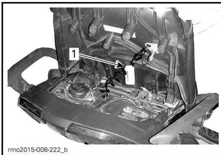
1. Étiquette 7 fixée au cordon d'attache, sous le siège du passager
