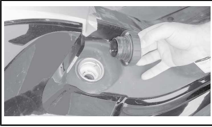
TAPPO DEL CARBURANTE SUL LATO SINISTRO SOTTO IL SEDILE
