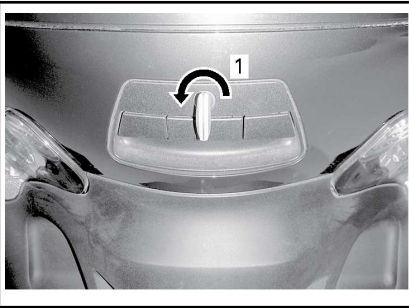
1. Linksom draaien om te ontgrendelen. De grendel optrekken.
