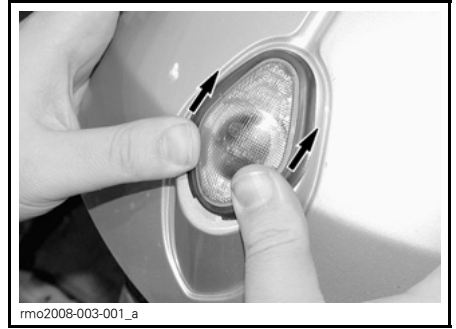
2. Løsne lykteglasset ved å løfte opp den fremre delen av lykteglasset med tommelen eller en liten skrutrekker.
