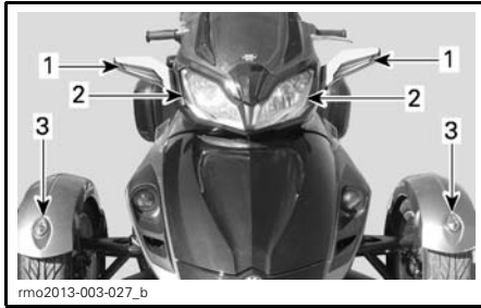
TYPIQUE - EMPLACEMENT DES FEUX – AVANT DU VÉHICULE
