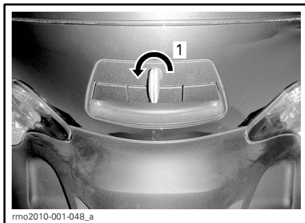
1. Tournez dans le sens antihoraire pour déverrouiller
