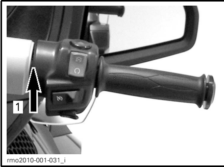
RÉGULATEUR DE VITESSE DÉSACTIVÉ PRÉCÉDEMMENT 1. Poussez le bouton vers le haut à «RESUME»
