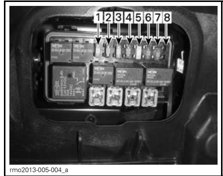
SICHERUNGEN - RECHTER SICHERUNGSKASTEN
