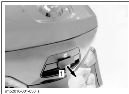
1. Apertura de la cubierta superior
