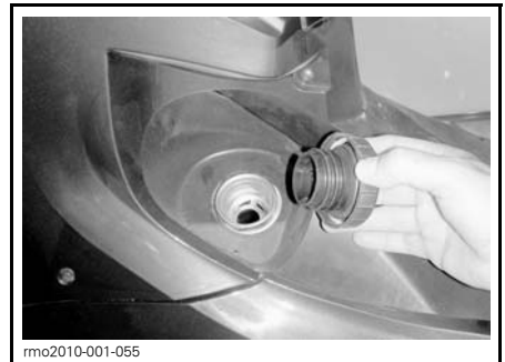
EL TAPÓN DEL DEPÓSITO DE COMBUSTIBLE ESTÁ EN EL LADO IZQUIERDO DEBAJO DEL ASIENTO
