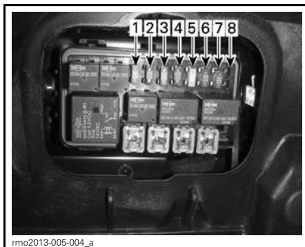
FUSIBLES - BOÎTE À FUSIBLES DROITE
