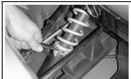
KAMJUSTERING AV FRAMHJULSFJÄDRING
