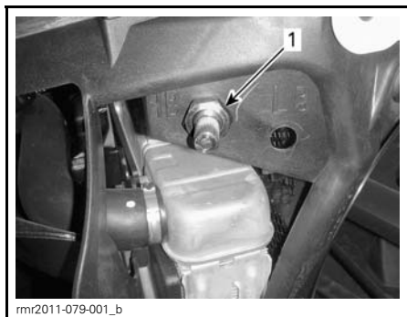
1. Porca de fixação do cabo de ajuste.
