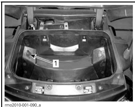
1. Tomada de energia
