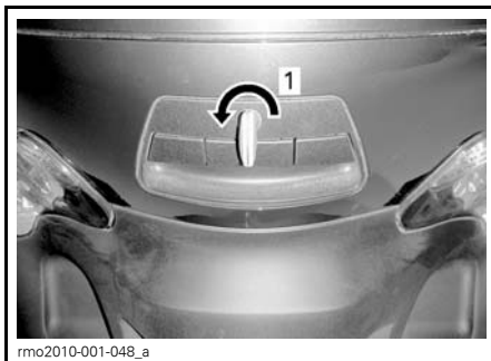
1. Vire no sentido anti-horário para destravar
