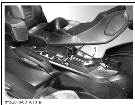
1. Sikringsboks plassert under setet
