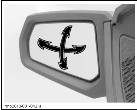
PUNTOS DE AJUSTE DEL RETROVISOR
