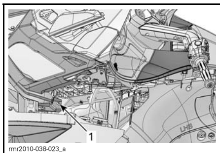
1. Tornillo de fijación de la parte media
