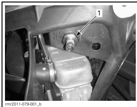
1. Tuerca de sujeción del cable de ajuste
