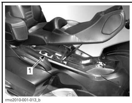
1. Depósito de líquido de frenos
