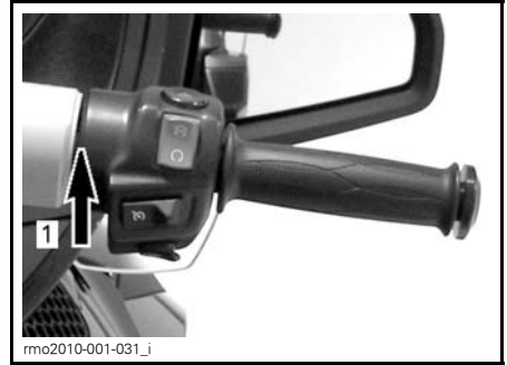
CONTROL DE CRUCERO ESTABLECIDO PREVIAMENTE 1. Pulse el botón hacia arriba para incrementar la velocidad de referencia
