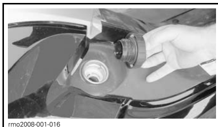
TAMPA DO TANQUE NO LADO ESQUERDO ABAIXO DO ASSENTO
