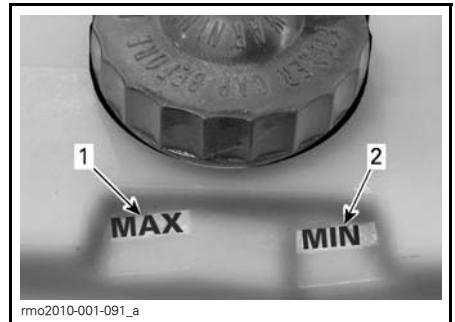
1. Marca de MÁX. do nível do fluido de freio 2. Marca de MÍN. do nível do fluido de freio
