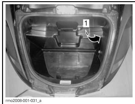
1. Nécessaire d'outils situé à l'avant du compartiment de rangement
