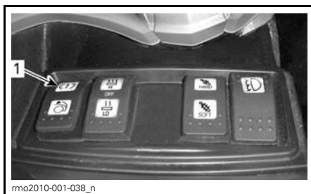
1. Interrupteur de frein de stationnement
