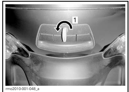
1. Tournez dans le sens antihoraire pour déverrouiller
