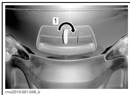
1. Tournez dans le sens horaire pour verrouiller
