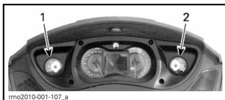
1. Medidor de temperatura do líquido de arrefecimento do motor
