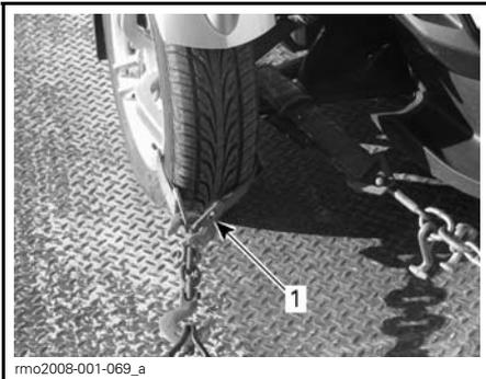
**TÍPICA FIXAÇÃO DAS RODAS DIANTEIRAS — MÉTODO 1**
