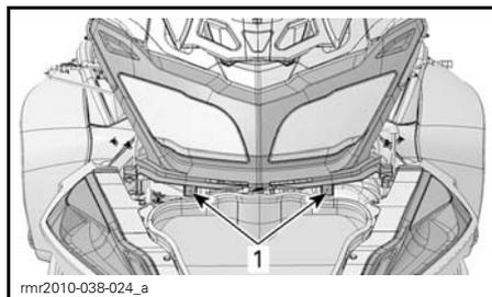
1. Parafuso de fixação inferior
