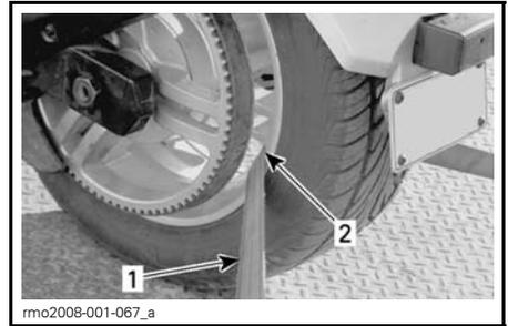
**TÍPICA FIXAÇÃO DA RODA TRASEIRA**
