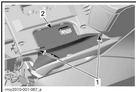
1. Parafusos de fixação
