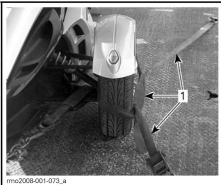
**TÍPICA FIXAÇÃO DAS RODAS DIANTEIRAS — MÉTODO 2**
