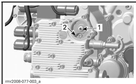
1. Orifício de saída de óleo para o sistema de lubrificação do módulo de controle hidráulico
