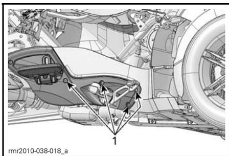
1. Parafusos de fixação
