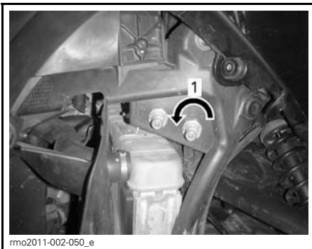
RECHTES SCHEINWERFER-EINSTELLKABEL 1. Anheben des Scheinwerferstrahls
