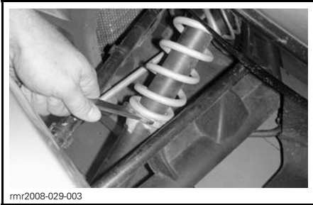
mmr2008-029-003 EINSTELLUNG DES NOCKENS DER FEDERUNG VORN
