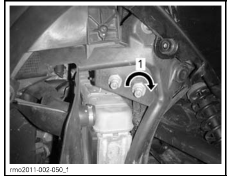
EINSTELLSCHRAUBE 1. Absenken des Scheinwerferstrahls
