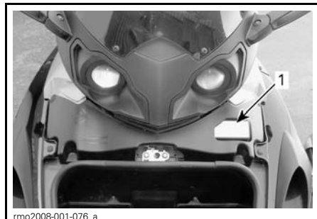
1. Säkringsbox innanför servicepanelen bakom det främre förvaringsutrymmet
