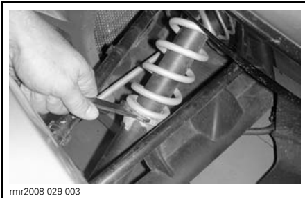
KAMJUSTERING AV FRAMHJULSFJÄDRING
