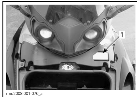
1. Sikringsboks plassert under servicedekslet bak oppbevaringsrommet foran
