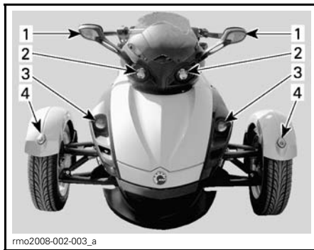
EMPLACEMENT DES FEUX — AVANT DU VÉHICULE
