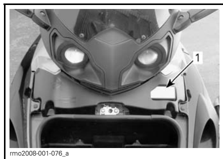
1. Caja de fusibles situada bajo la cubierta de servicio, detrás del compartimento de almacenamiento delantero
