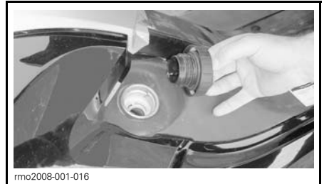
EL TAPÓN DEL DEPÓSITO DE COMBUSTIBLE ESTÁ EN EL LADO IZQUIERDO DEBAJO DEL ASIENTO
