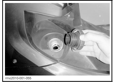
EL TAPÓN DEL DEPÓSITO DE COMBUSTIBLE ESTÁ EN EL LADO IZQUIERDO DEBAJO DEL ASIENTO
