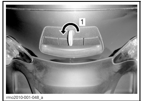
1. Gire en sentido contrario al de las agujas del reloj para desbloquear
