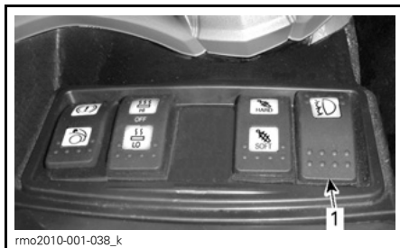
1. Interruptor de luces antiniebla
