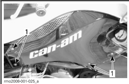
1. Torx-schroeven van het bovenste zijpaneel
