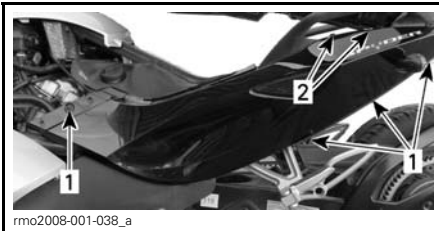
1. Vis Torx 2. Rivets de plastique
