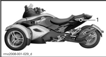
1. Batteri plassert bak bakre sidepanel på venstre side
