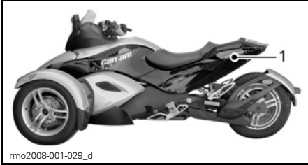
1. Batteri plassert bak bakre sidepanel på venstre side
