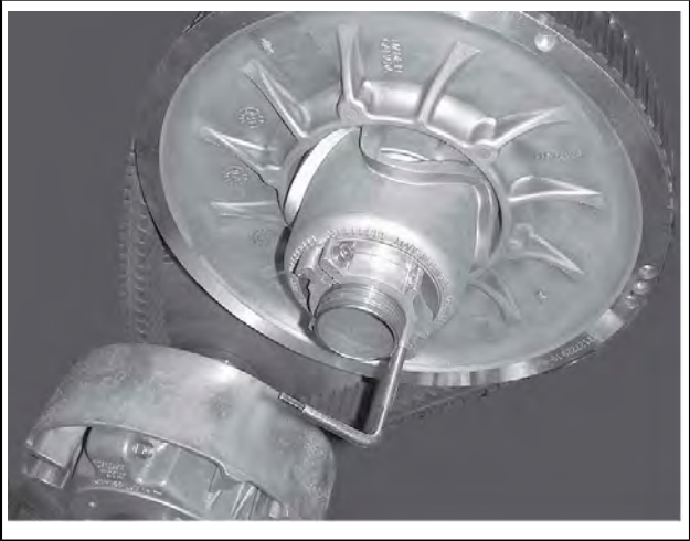
TYPISCH - SCHEIBEN-EXPANDER AN NABE DER EINSTELL-VORRICHTUNG MONTIERT
