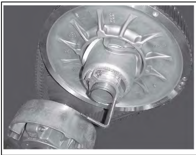
TYPBILD - VARIATORUTVIDGARE INSTALLERAD PÅ JUSTERINGSNAVET
