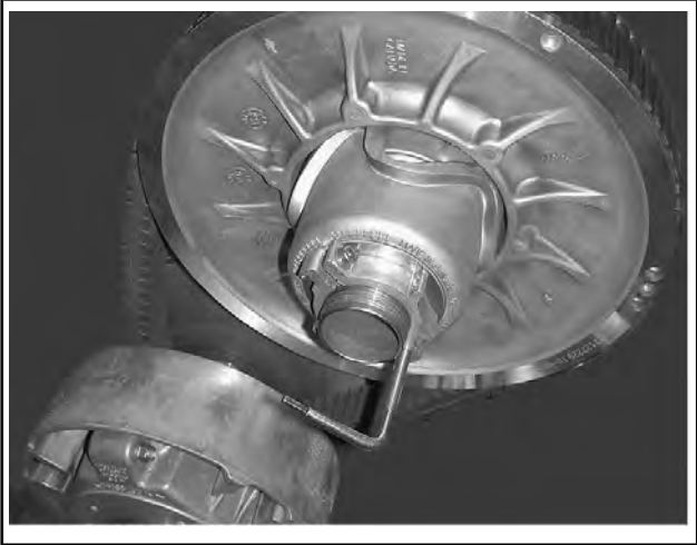
TYPISCH - SCHEIBEN-EXPANDER AN NABE DER EINSTELL- VORRICHTUNG MONTIERT
