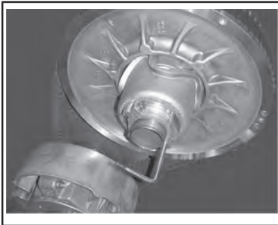
VARIATORNS UTVIDGARE PÅ JUSTERINGSNAV
