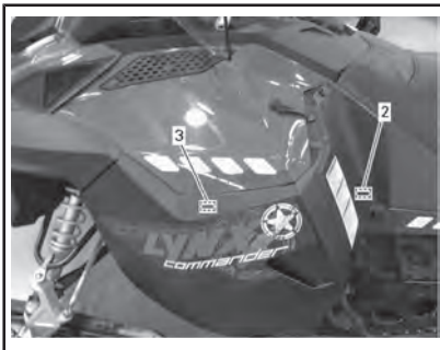
TYPBILD - NRMM-IDENTIFIERING PÅ MOTORN
