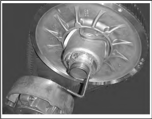
TYPISCH - SCHEIBEN-EXPANDER AN NABE DER EINSTELLVORRICHTUNG MONTIERT
