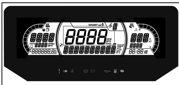
Anzeige der Fahrzeuggeschwindigkeit in km/h (oder mph) oder der Drehzahl in 1/min. Siehe EINSTELLUNGEN .
