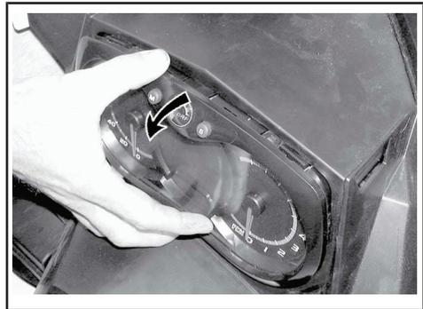
3. Débranchez le connecteur de l'ampoule grillée. Retirez la gaine en caoutchouc.
