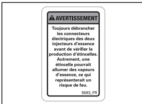
ÉTIQUETTE 11 - SUR LES INJECTEURS DE CARBURANT - MODÈLES 600 HO E-TEC
